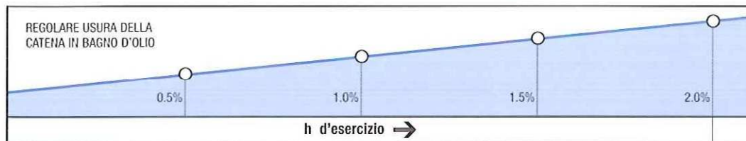
Diagramma [ fC ] = fattore resistenza all'USURA
