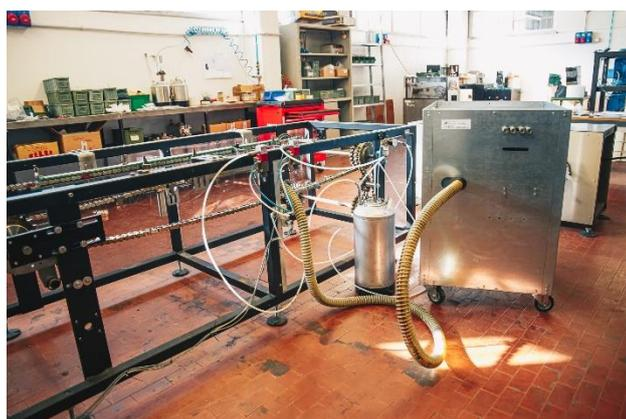
Macchina test per la lubrifcazione
